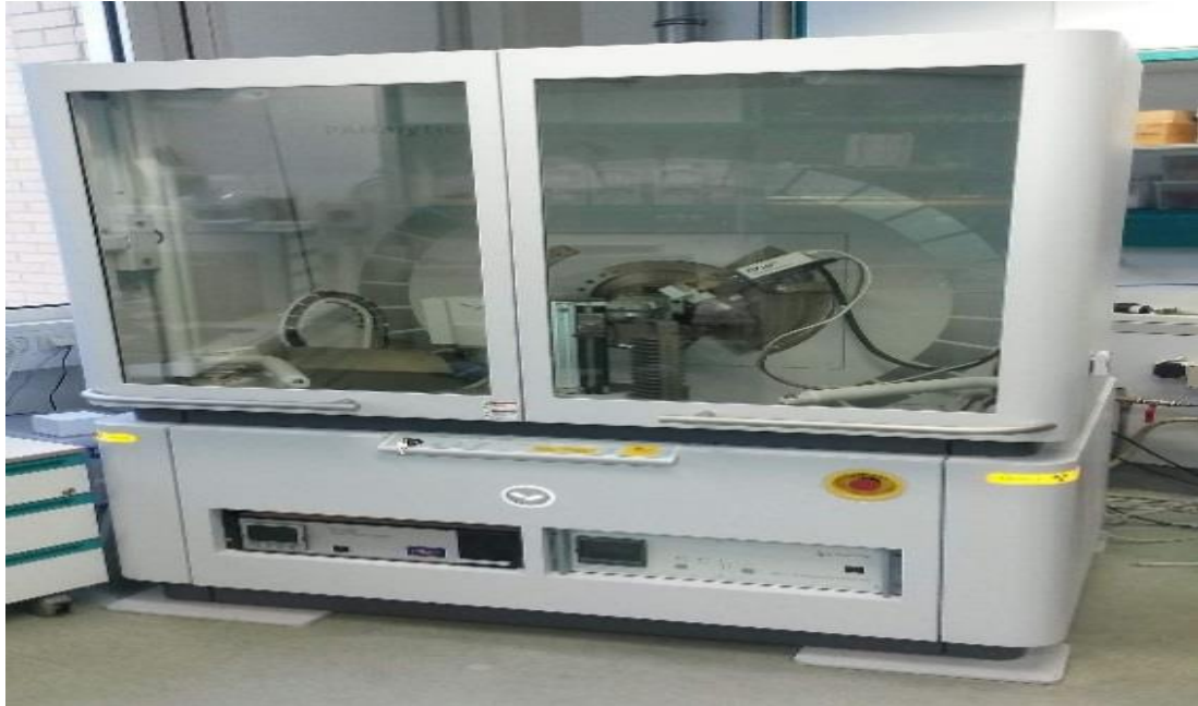
الشكل (2-3): حيود الاشعة السينية (XRD) الموجودة في جامعة طهران .
