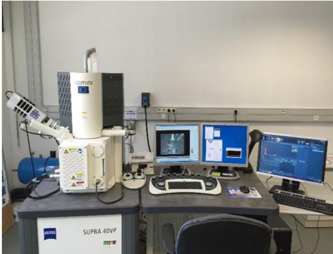
الشكل (3-4) : المجهر الالكتروني الماسح SEM الموجود في جامعة طهران .
