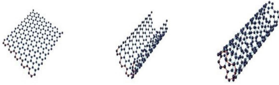
الشكل (1- 7) التفاف صفيحة الجرافيت لتشكيل الأنابيب النانوي. [12]
